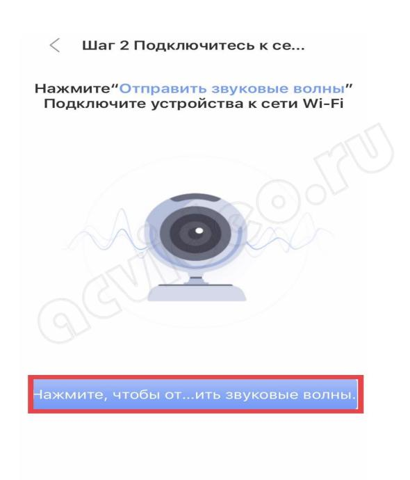
12. Ваш телефон начнет издавать звуковые сигналы, благодаря которым выполнится автоматическая настройка камеры видеонаблюдения и ее подключение к Wi-Fi роутеру. Эта настройка может заниматься от 20 до 100 секунд.
