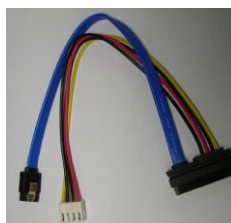
Кабели для установки жесткого диска
