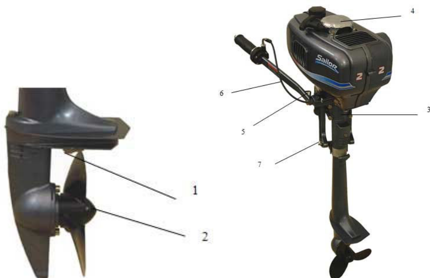
Рис.3. 1.Анод. 2.Винт-шпонка срезной. 3.Кронштейн крепления поворотный. 4.Кожух стартового шнура. 5.Кабель СТОП кнопки. 6.Трос управления дросселем. 7.Регулировка угла наклона мотора.
