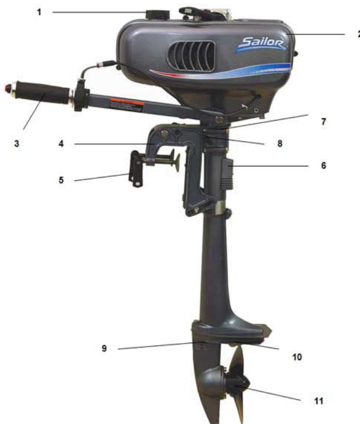
Рис.1. 1 - крышка топливного бака, 2 - защитный кожух мотора, 3 - ручка управления, 4 - скоба крепления к транцу, 5 - зажимы транцевые, 6 - крышка глушителя, 7 - поворотный шарнир, 8 фиксатор, 9 - водозаборный канал, 10 - антикавитационная пластина. 11 - гребной винт.
