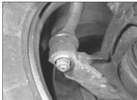
13.2a Loosen the balljoint nut . . .
