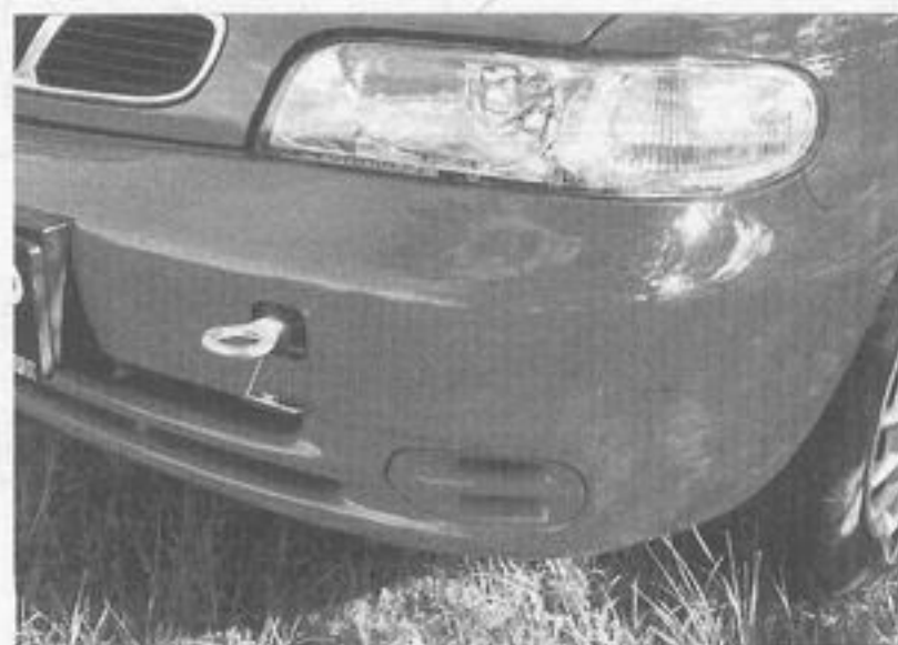
ZACZEP HOLOWNICZY UMOCOWANY DO BELKI PRZEDNIEGO ZDERZAKA
