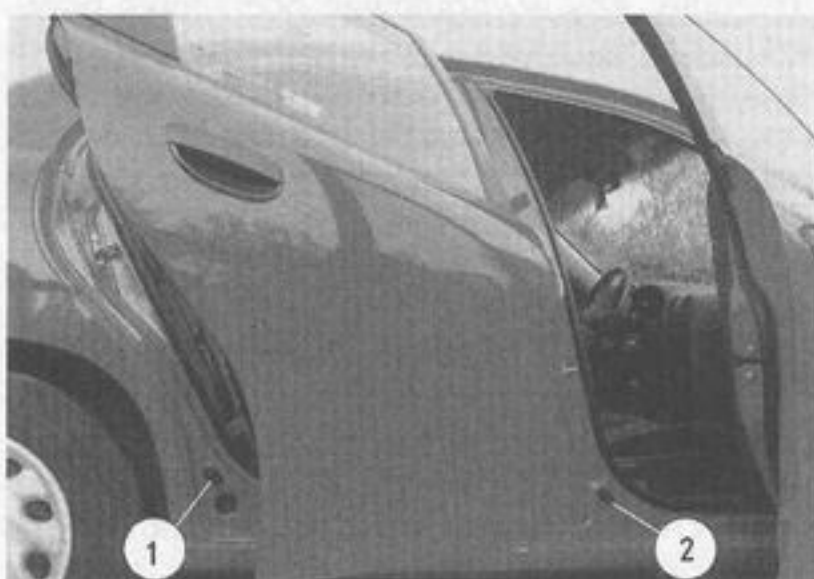
WŁĄCZNIKI LAMPKI OŚWIEPLENIA WNĘTRZA 1 – w tylnych drzwiach, 2 – w przednich drzwiach
