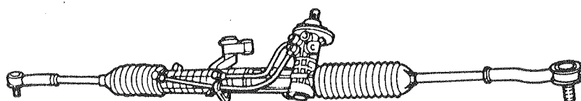
Rys. 6.8. Widok kompletnej przekładni kierowniczej ze wspomaganiem po wymontowaniu z samochodu
