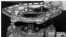
Rys. 5.12. Zdejmowanie płyty ustalania łożysk tylnych
