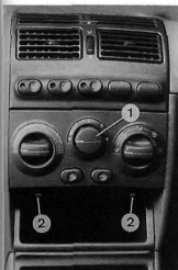
Rys. 11.10. Wymontowanie płytki sterowaniem 1 — środkowe pokrętło sterowania reostatem (śruba mocująca znajduje się za pokrętkiem), 2 — śruba mocująca płytkę sterowania
