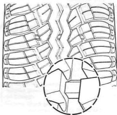
Rys. 0.47. Wskaźniki zużycia bieżnika na oponach
