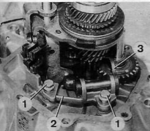
Rys. 4.17. Wymontowanie zespołu sterowania z widelkami biegu wstępnego 1 — śruby mocowania zespołu, 2 — element sterowania, 3 — widelki wstępnego biegu
