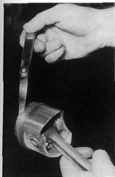
Rys. 1.41. Sprawdzenie luzu pierścienia w rowku
