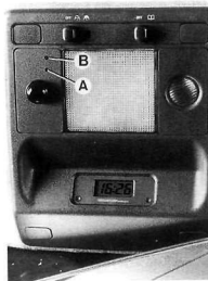
Rys. 0.31. Programowanie urządzenia zdalnego sterowania A — przycisk, B — dioda
