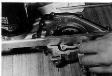
Rys. 1.51. Sprawdzanie luzu między kołami zębatymi a pokrywą pompy
