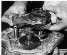
Rys. 5.30. Zamontowanie koła zębatego 5. biegu wraz z synchronizatorem i widełkami
