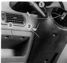
Rys. 11.14. Wymontowanie obudów kolumny kierowniczej 1 — obudowa górna, 2 — obudowa dolna, 3 — osłona dostępu do płytki bezpieczników
