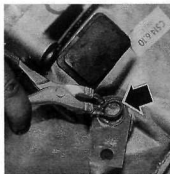
Rys. 4.22. Zdejmowanie pierścienia sprężynującego z dźwigni sterowania sprzęgła
