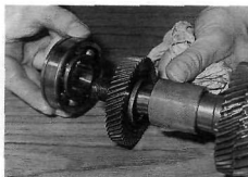
Rys. 5.20. Zdejmowanie łożyska wałka głównego, koła zębatego 4. biegu i tulei dystansowej
