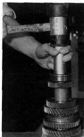
Rys. 5.20. Zdejmowanie łożyska wałka głównego, koła zębatego 4. biegu i tulei dystansowej
