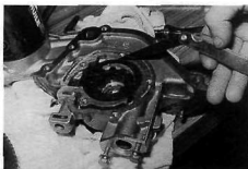
Rys. 1.50. Sprawdzanie luzu między zewnętrznym kołem zębatym a obudową pompy oleju
