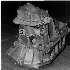
Rys. 5.13. Usytuowanie kulek blokowania (1) i śruby mocowania (2) wałka wstecznego biegu
