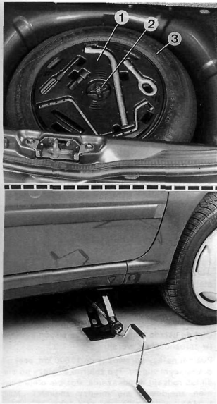
Rys. 0.43. Narzędzia z wyposażenia samochodu (rys. górny) i sposób umieszczenia podnośnika (rys. dolny) 1 — narzędzia z wyposażenia samochodu, 2 — nakrętka blokująca, 3 — koło zapasowe
