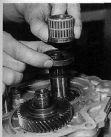
Rys. 5.10. Wymywanie tulei i łożyska igielkowego koła zębatego 5. biegu
