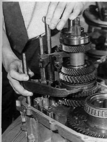
Rys. 5.24. Montaż widełek biegów 5.—wstęcznego oraz biegów 3—4
