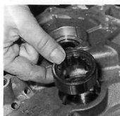
Rys. 5.15. Wyjmowanie łożyska wałka głównego
