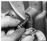
Rys. 5.27. Różne elementy mocowania w obudowie sprzęgła 1 — śruba mocowania obudowy zespołu kół zębatych, 2 — tuleja prowadzenia łożyska wyciskowego sprzęgła i wspornik pierścienia uszczelniającego wałka sprzęgłowego, 3 — wałek sprzęgłowy
