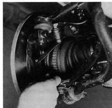
Rys. 10.20. Sprawdzenie szczeliny powietrznej czujnika koła przedniego
