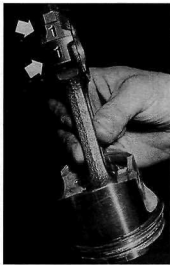
Rys. 1.46. Oznaczenie numeru cylindra na korbowodzie
