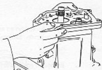
Rys. 6.9. ZDEJMOWANIE PŁYTY POSREDNIEJ
