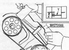
Rys. 3.9. SPRAWDZANIE NAPIĘCIA PASKA ZĘBATEGO
