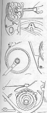
Rys. 4.41. USTAWIANIE KOŁ ROZRZĄDU
