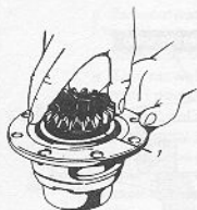
Rys. 6.16. REGULACJA LUZU MIĘDZYZĘBNY KÓŁ MECHANIZMU RÓŻNICOWEGO
