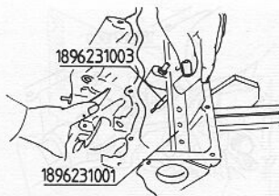
Rys. 4.20. POMIAR WYSTAWIANIA TRZONKA ZAWORU
