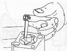
Rys. 4.38. POMIAR LUZU MIĘDZY KOŁAMI
