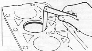
Rys. 2.34. POMIAR LUZU ZAMKA PIERŚCIENIA TŁOKOWEGO
