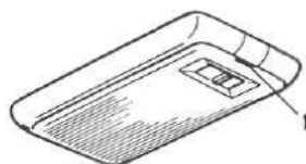
Rysunek 7.50 LAMPY OŚWIETLENIA WNĘTRZA 1 — wycięcie w kloszu ułatwiające wsunięcie wkrętaka podczas zdejmowania klosza
