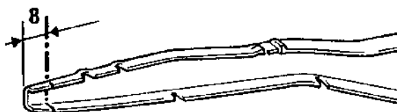
Rys. 3.62. SKRACANIE ODRZUTNIKA OLEJU Z TWORZYWA SZTUCZNEGO
