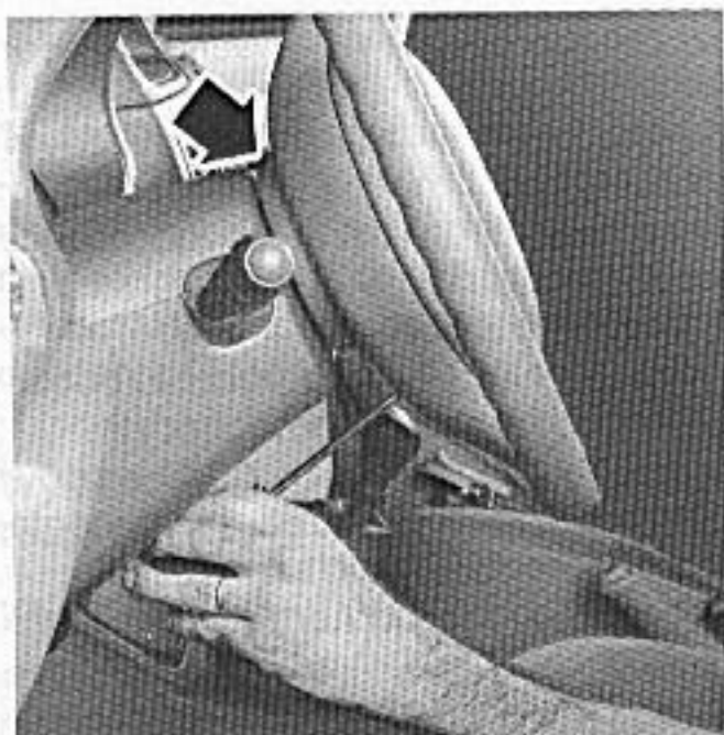
Rys. 11.43. Usytuowanie wkrętów mocowania zespołu poduszki powietrznej kierowcy
