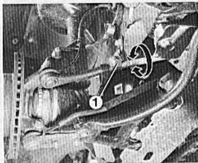
Rys. 8.6. Regulacja zbieżności kół przednich 1 – śruba obejmująca drążek kierowniczy
