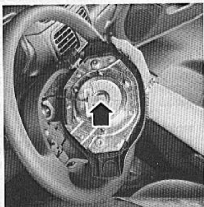
Rys. 11.44. Usytuowanie złącza elektrycznego poduszki powietrznej
