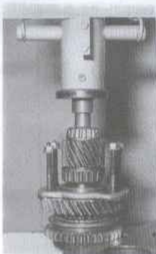
Rys. 5.27. Zamontowanie synchronizatora biegów 1 — 2 (kol. RTA).
