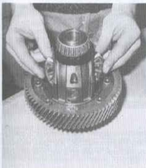
Rys. 5.30. Zamontowanie kół koronowych w obudowie mechanizmu różnicowego (ot. RTA)
