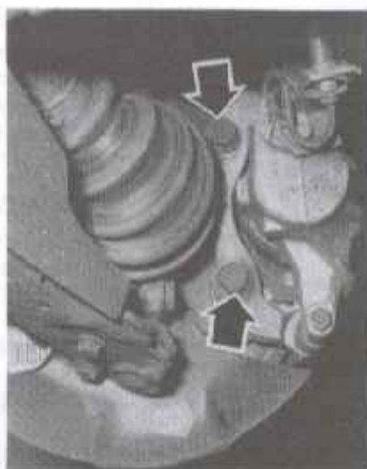
Rys. 10.4. Wymontowanie zacisku kompletnego (lot. RTA)
