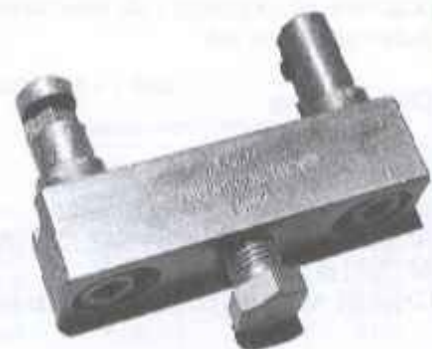
Rys. 14.5. Ściągacz koła zębatego pompy wtryskowej — silnik wysokoprężny (VW 3032)
