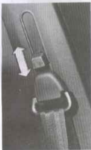
Rys. 0.31. Regulacja pionowa punktu mocowania przednich pasów bezpieczeństwa (fol. RTA)
