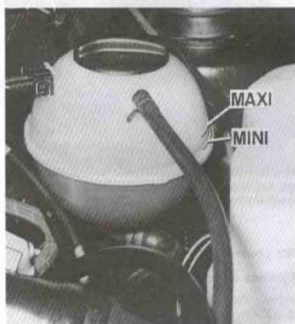
Rys. 0.39. Oznaczenie poziomów cieczy chłodzącej w zbiorniku wyrównawczym układu chłodzenia (fot. RTA)
