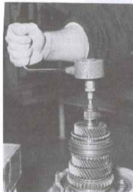
Rys. 5.26. Sprawdzanie momentu obrotu wałka głównego (ot. RTA)
