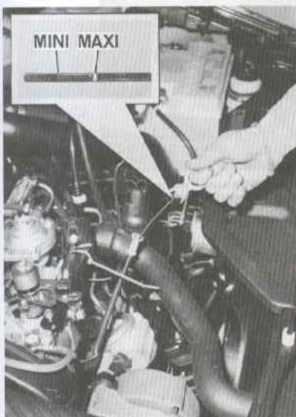
Rys. 0.37. Sprawdzenie poziomu oleju w silniku (fot. RTA) U góry: silnik benzynowy, u dołu: silnik wysokoprężny
