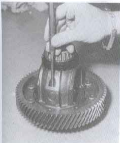
Rys. 5.29. Wcisnięcie kołka w osi satelitów przed wybiciem osi satelitów (ot. RTA)
