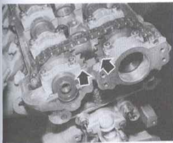
Rys. 2.20. Sposób zamontowania kół zębatach wałów rozrządu (fol. RTA) Strzałki wskazują znaki kół zębatach
