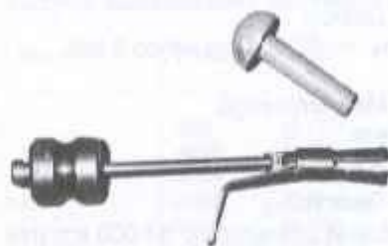
Rys. 14.2. Ściągacz i element popychający do uszczelniaaczy trzonków zaworów
