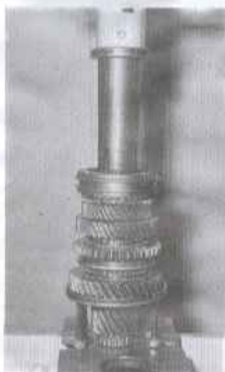
Rys. 5.21. Wałek główny — zamontowanie synchronizatora biegów 3 — 4
