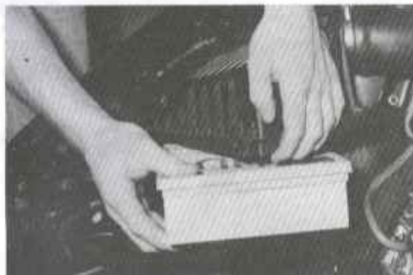
Rys. 0.41. Wymiana wkładu filtra powietrza w silniku wysokoprężnym (fot. RTA)
