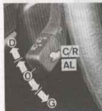
Rys. 0.17. Przełącznik świateł drogowych i mijania, sygnalizacji świetlnej oraz kierunkowskazów (fot. RTA) C/R, AL — przełączenie rodzaju świateł i sygnalizacji świetlnej, D — kierunkowskaz prawy, G — kierunkowskaz lewy
