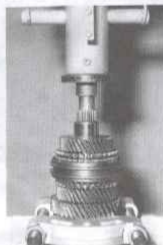
Rys. 5.17. Demontaż wałka głównego na prasie z uchwyceniem pod kołem zębatym 2. biegu (fot. RTA)
