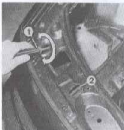
Rys. 11.14. Regulacja reflektorów (fot. RTA) 1 — regulacja pionowa, 2 — regulacja pozioma
