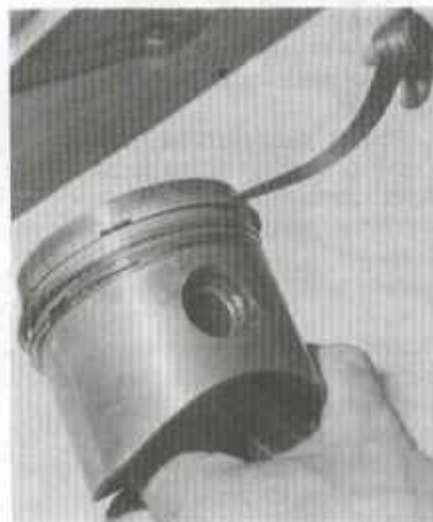
Rys. 1.50. Sprawdzanie luzu w rowku pierścienia tłokowego (fot. RTA)
