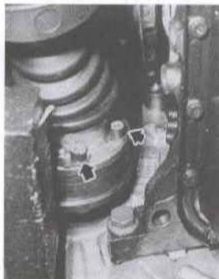
Rys. 6.1. Śruby i specjalne podkładki mocowania półosi do kołnierza (ot. RTA)
