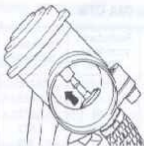
Rys. 16.18. Sposób sprawdzania przesuwu trzpienia przepony siłownika zaworu recyrkulacji spalin
