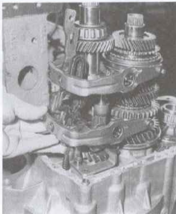
Rys. 5.33. Zamontowanie widełek (fot. RTA)
