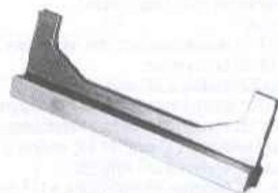
Rys. 14.4. Liniat do ustawiania wału rozrządu — silnik wysokoprężny (VW 2065)
