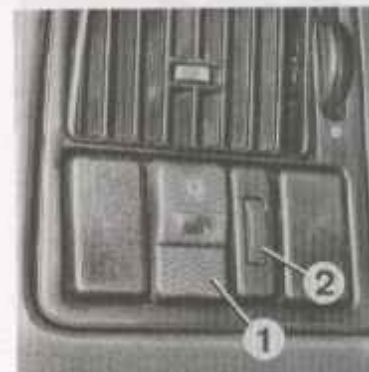
Rys. 0.16. Przełączniki oświetlenia (fot. RTA) 1 — przełącznik świateł pozycyjnych oraz drogowych i mijania, 2 — reostat oświetlenia zestawu wskaźników
