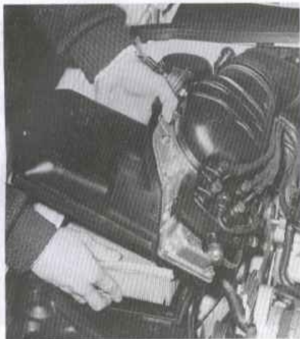
Rys. 0.40. Wymiana wkładu filtra powietrza w silniku 16 – zaworowym (fot. RTA)
