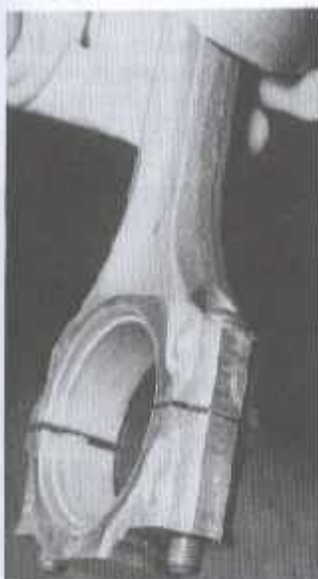
Rys. 3.28. Składanie korbowodu z pokrywą podczas montażu silnika (fot. RTA)
