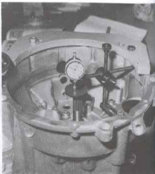
Rys. 5.28. Pomiar luzu łożysk wałka sprzęgłowego (kol. RTA).
