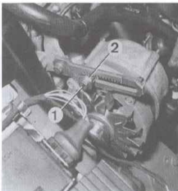
Rys. 11.1. Regulacja naciągu paska napędu alternatora (fol. RTA)
