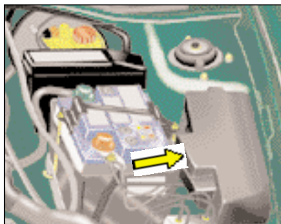
Предохранители в моторном отсеке.
