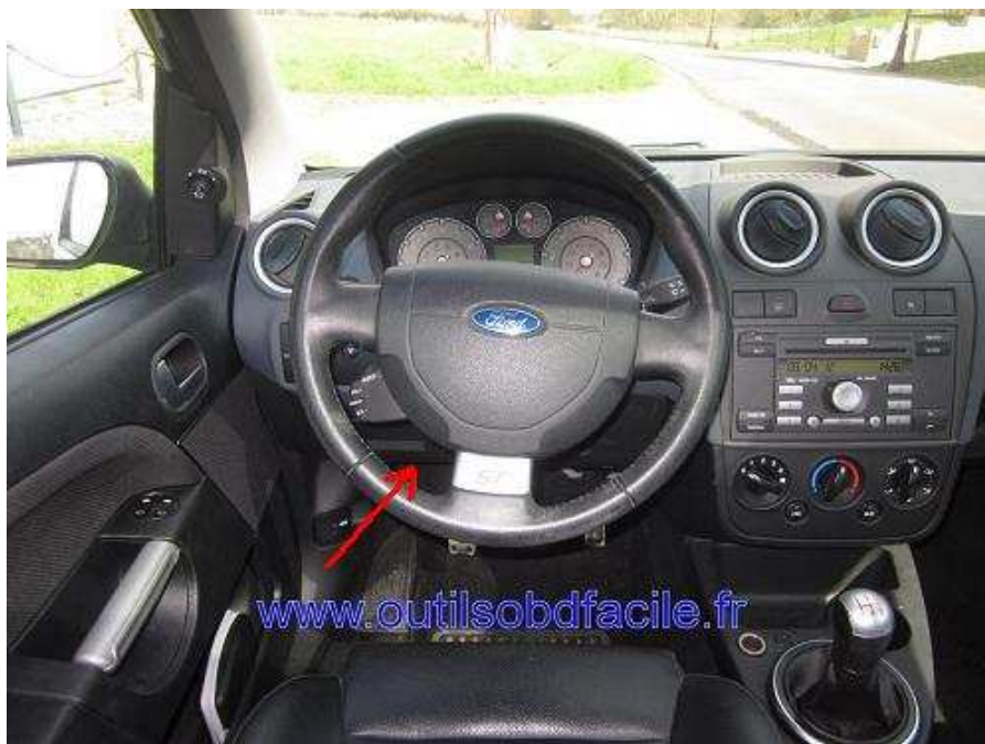
Le connecteur se situe sous le volant
