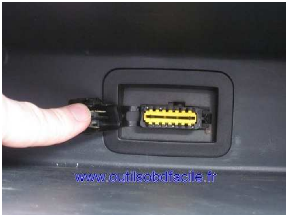
Déclipser le cache en appuyant sur le dessus de celui-ci et tirer vers la gauche
