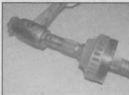
Рис. 16.25. Резким ударом молотка по ШРУСу надвиньте его на приводной вал, при этом стопорное кольцо войдет в канавку шарнира
