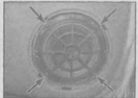
Рис. 20.80. Расположение винтов крепления динамика
