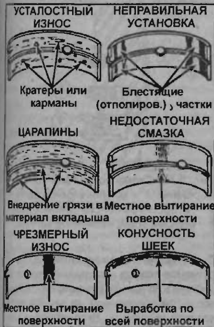
Рис. 6.43. Типичные виды износа вкладышей коренных и шатунных подшипников коленчатого вала
