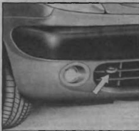
Расположение буксирной петли для буксировки за переднюю часть автомобиля
