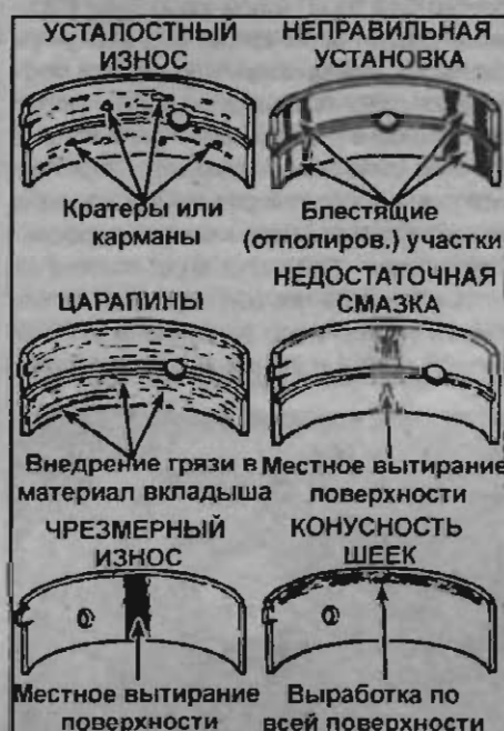
Рис. 5.33. Типичные виды износа вкладышей коренных и шатунных подшипников коленчатого вала
