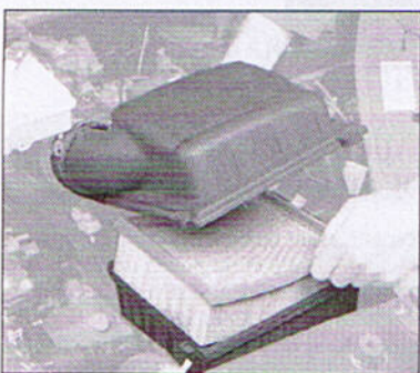
Extraction de la cartouche filtrante de son boîtier.
