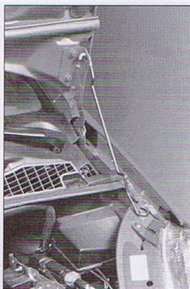
Mise en place de la béquille de maintien du capot moteur.
