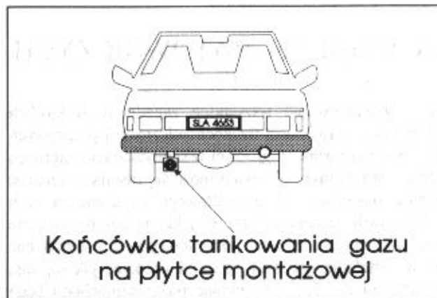
Rys. 23. Końcówka tankowania gazu umieszczona na płycie montażowej
