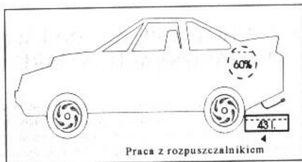
Rys.16. Umieszczenie tacy z rozpuszczalnikiem w czasie testu.
