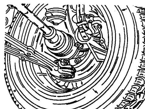
Rys. 6.3. POŁĄCZENIE (1) WAHACZA Z DOLNĄ CZĘŚCIĄ KOLUMNY McPHERSONA
