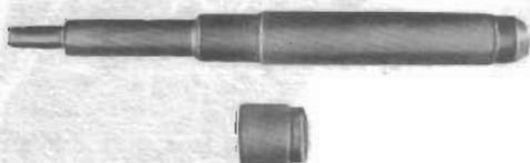
A.60153 Wybijak z tulejką dystansową do montażu i demontażu prowadnic zaworów
