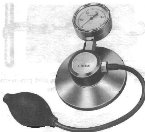
A.95868 Przyrząd do sprawdzania szczelności zaworów
