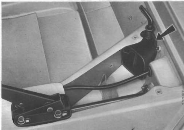
Przepustnica ciepłego powietrza (widok po zdjęciu pokryw)
