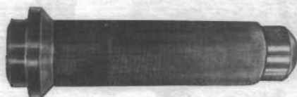
A.74041/1 Trzpień do montażu pierścienia zewnętrznego łożyska wewnętrznego kół przednich dla układu hamulcowego wzmocnionego
