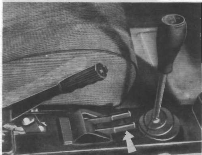
Umiejscowienie dźwigni przepustnicy ciepłego powietrza w samochodzie „FL”
