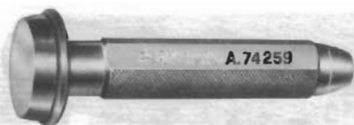
A.74259 Trzpień do montażu pierścienia zewnętrznego łożyska wewnętrznego kół przednich dla układu hamulcowego przedmiannowego, standardowego
