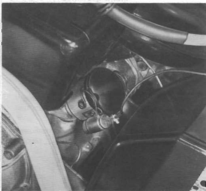
Widok ogólny aparatu zapłonowego bezrozdzielaczowego
