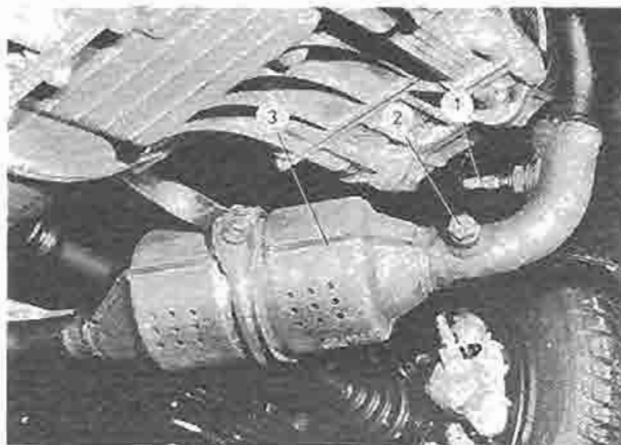
Przednia rura wylotowa z katalizatorem i sondą lambda w samochodzie z silnikiem 704 cm 3
