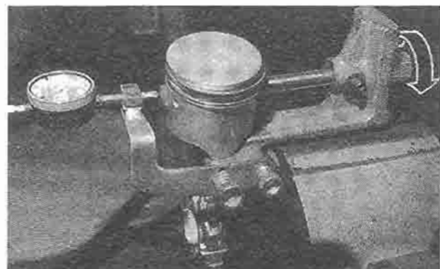
Sprawdzanie siły niezbędnej do przesunięcia sworznia tłoka za pomocą przyrządu FIAT
