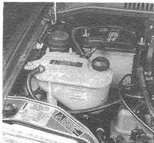
Zbiornik wyrównawczy układu chłodzenia
