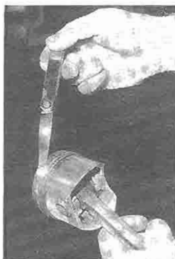
Sprawdzanie luzu pierścienia w rowku tłoka
