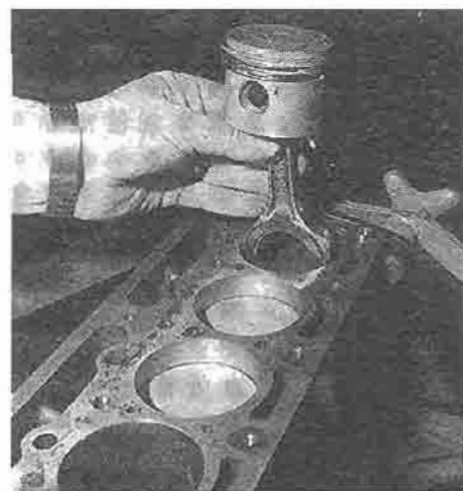
Wkładanie zespołu tłok—korbowód do cylindra
