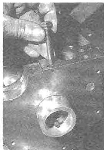
Wkręcanie śruby mocowania przedniej tulejki wału rozrządu
