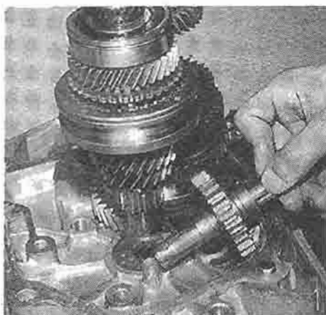
Wymontowanie wałka i koła zębatego biegu wstecznego
