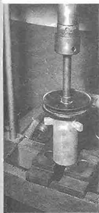
Ściąganie na prasie koła pasowego z wałka wirnika pompy cieczy chłodzącej
