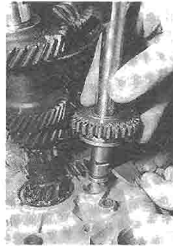
Wymywanie wałka i koła zębatego biegu wstecznego
