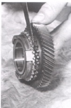
Rys. 15.57. Sprawdzenie luzu pierścienia synchronizatora na koło zębate
