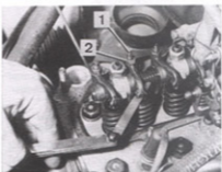
Rys. 1.3. Regulacja zaworów 1 — śruba regulacyjna, 2 — przeciwną krętką
