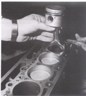
Rys. 1.39. Składanie zespołu tłok — korbowód
