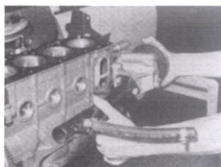
Rys. 14.56. Wymontowanie pompy cieczy chłodzącej
