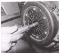
Rys. 3.3. Środkowanie tarczy sprzęgła (fot. RTA)
