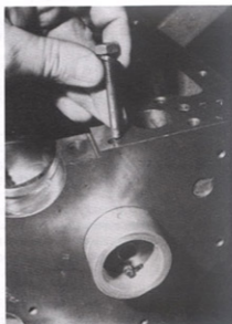
Rys. 1.42. Zakładanie śruby ustalającej tuleję (od strony rozrządu) wału rozrządu
