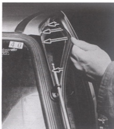
Rys. 11.22. Zakładanie gumowej rynienki
