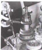
Rys. 15.51. Wymontowanie zespołu widełek biegów 3-4 wraz z osią widełek biegów 1-2
