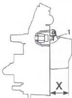
Rys. 2.8. Regulacja poziomu paliwa w komorze pływakowej
