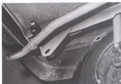
Rys. 11.29. Dolne mocowanie zderzaka tylnego
