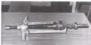
Rys. 15.55. Ściąganie zespołu kół zębatych 3. i 4. biegu oraz tylnego łożyska wałka sprzęgłowego
