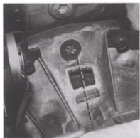
Rys. 1.8. Znaki do ustawiania kąta początkowego wyprzedzenia zapłonu (fot. RTA)
