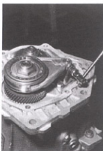
Rys. 15.43. Wykręcanie śruby mocowania widełek 5. biegu
