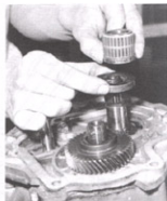
Rys. 15.44. Wyjmowanie łożyska igielkowego i pierścienia oporowego koła zębatego 5. biegu
