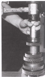
Rys. 15.60. Montowanie tylnego łożyska tocznego na wałek główny za pomocą trzpienia
