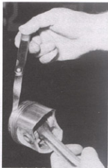
Rys. 2.22. Sprawdzenie luzu pierścieni w rowkach
