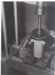
Rys. 1.49. Zdejmowanie na prasie koła pasowego pompy ciecizy chłodzącej
