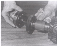
Rys. 14.73. Zdejmowanie łożyska wałka głównego, koła zębatego 4. biegu i tulei dystansowej
