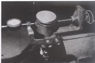
Rys. 1.36. Sprawdzenie przesuwania sworznia tłokowego (fot. RTA)
