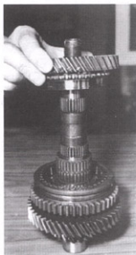
Rys. 15.59. Wymywanie koła zębatego 2. biegu Należy zwrócić uwagę na położenie koła zębatego względem tulei przesuwnej synchronizatora
