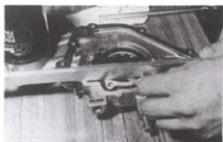
Rys. 2.33. Pomiar luzu osiowego kół zębatach
