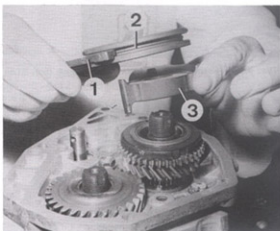
Rys. 4.1. Wymontowanie elementów sterowania 5. biegiem (fot. RTA)
