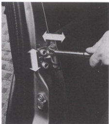
Rys. 11.10. Regulacja odstępu i przylegania przednich i tylnych drzwi względem innych elementów nadwozia (za pomocą zawiasów)
