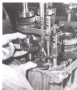
Rys. 15.50. Wymontowanie zespołu koła zębatego pośredniego z osią biegu wstecznego oraz widełek biegu wstecznego
