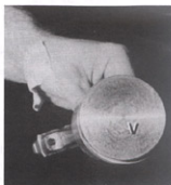
Rys. 2.29. Znak orientacji tłoków (w stronę rozrządu)
