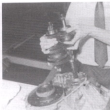
Rys. 14.67. Wymywanie zespołu przekładni zębatych
