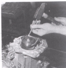
Rys. 14.61. Odblokowywanie nakrętki wałka sprzęgłowego
