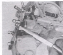
Rys. 1.21. Regulacja otwarcia przesłony rozruchowej
