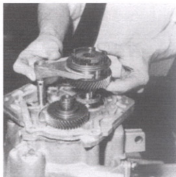
Rys. 14.84. Zakładanie koła zębatego 5. biegu z synchronizatorem i widełkami sterowania
