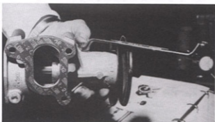
Rys. 1.48. Odkręcanie śruby z czopem mocowania łożyska
