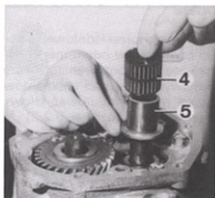
Rys. 4.2. Wymontowanie łożyska igielkowego i tulejki koła zębatego 5. biegu — opis w tekście (fot. RTA)
