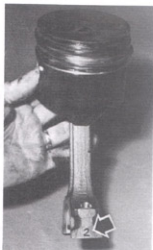
Rys. 15.31. Prawidłowe złożenie tłoka z korbowodem
