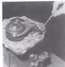
Rys. 14.62. Wykręcanie śruby widełek 5. biegu
