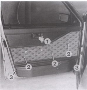
Rys. 11.12. Wymontowywanie płata pokrycia drzwi 1 — klamka, 2 — punkty mocowania podłokietnika, 3 — mocowanie kieszeni
