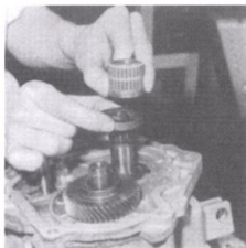
Rys. 14.63. Zdejmowanie łożyska igiełkowego i pierścienia oporowego koła zębatego 5. biegu
