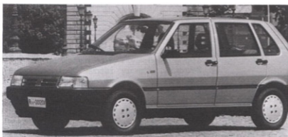
Rys. 0.3. FIAT Uno w wersji pięciodrzwiowej z dodatkowym oknem bocznym w tylnej części
