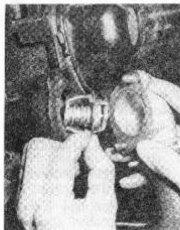
Rys. 1.50. Sposób zamontowania termostatu (fot. RTA)
