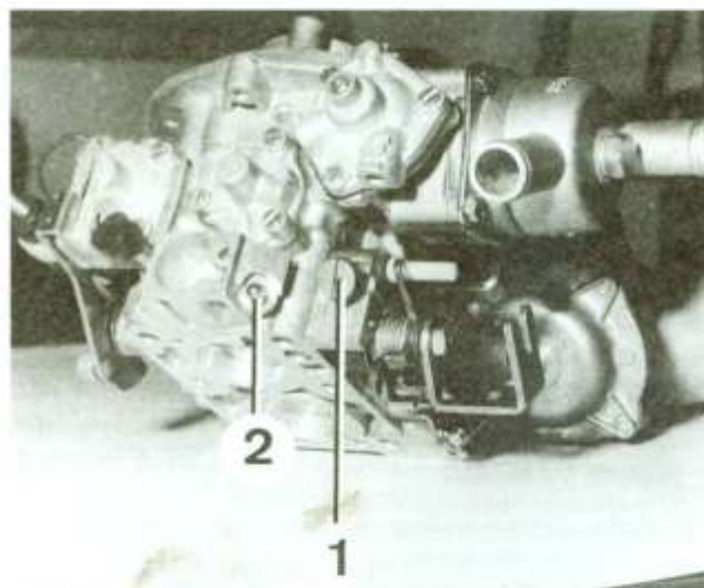
Rys. 2.20. Usytuowanie wkrętów regulacji biegu jałowego gaźnika Weber TLD (fot. RTA) 1 — wkręt regulacji prędkości obrotowej, 2 — wkręt regulacji składu mieszanki (zawartości CO)
