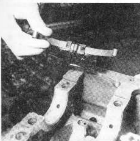
Rys. 2.39. Wyjmowanie odrzutnika oleju z kadłuba (fot. RTA)
