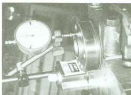
Rys. 3.32. Pomiar luzu osiowego wału korbowego (fot. RTA)
