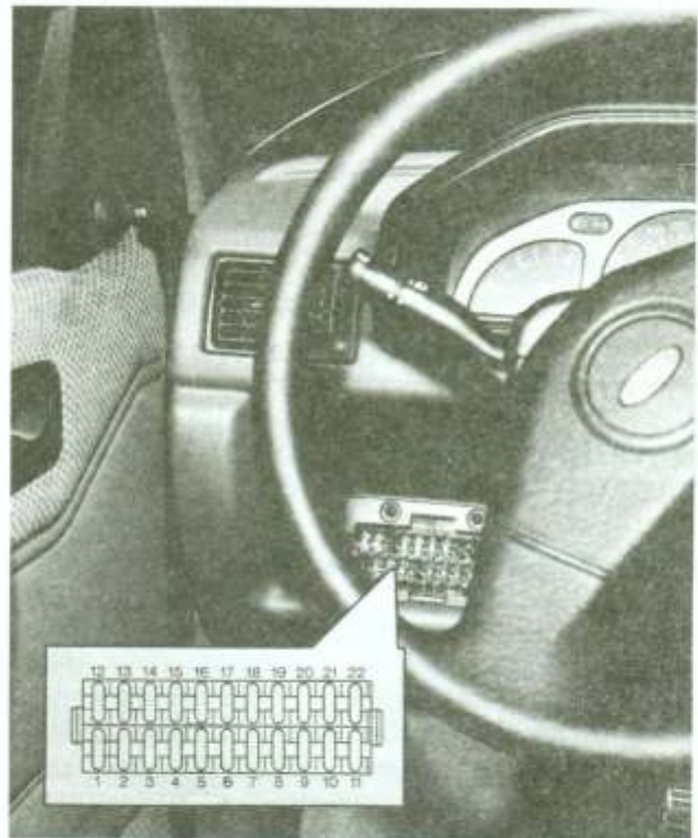
Rys. 13.12. Rozmieszczenie bezpieczników (fot. RTA)
