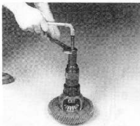
Rys. 17.77. Wymontowanie łożyska stożkowego z pierścieniem wewnętrznym z obudowy mechanizmu różnicowego
