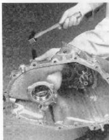
Rys. 17.78. Wymontowanie z obudowy sprzęgła zewnętrznego pierścienia łożyska stożkowego obudowy mechanizmu różnicowego za pomocą przyrządu 15-074
