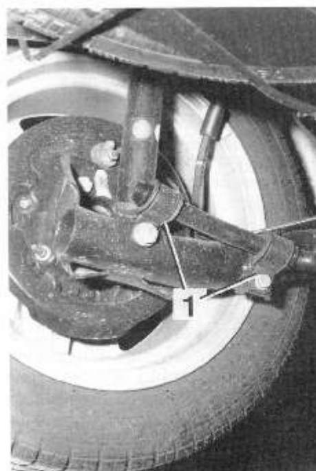
Rys. 17.98. Stabilizator zawieszenia tylnego 1 — obejmę tulei metalowo-gumowych drążka stabilizatora
