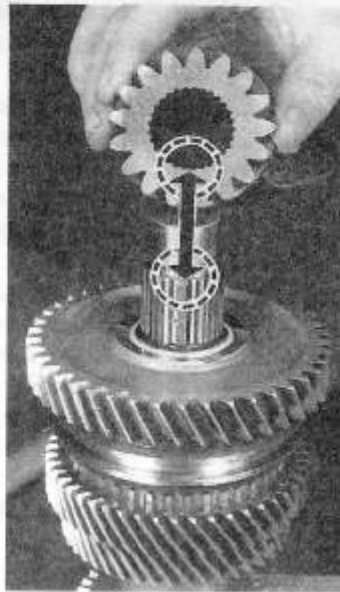
Rys. 17.85. Zamontowanie zębniaka przekładni głównej
