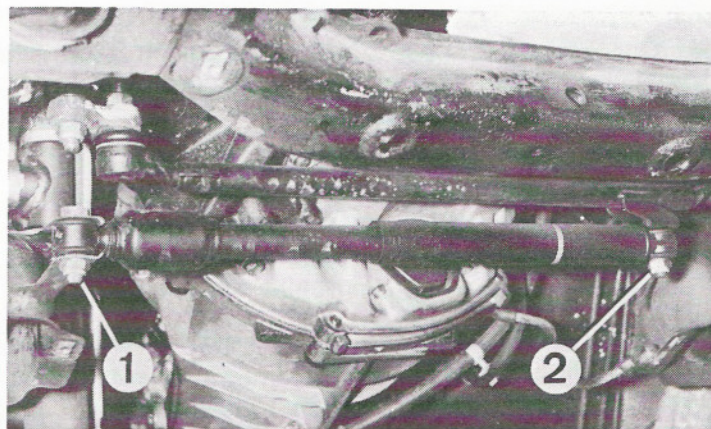
Rys. 8.6. Mocowanie amortyzatora układu kierowniczego (fot. RTA)
