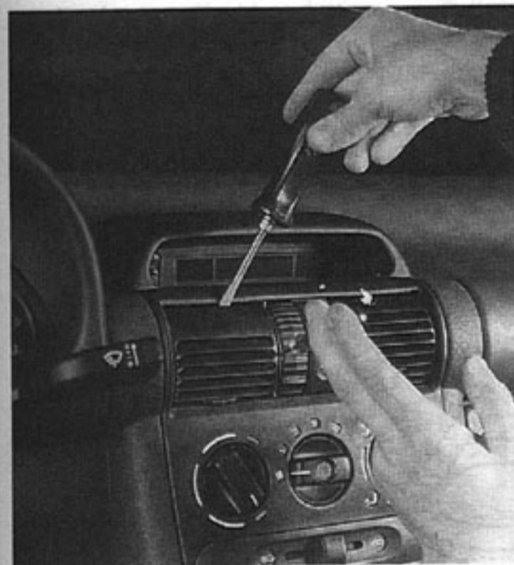
Rys. 11.25. Wymontowanie i zamontowanie wylotów nawiewów
