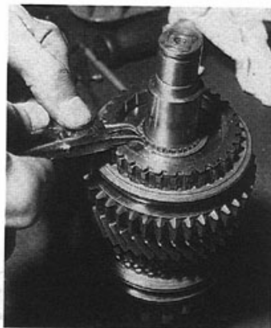
Rys. 4.20 Zdejmowanie pierścienia sprężynującego synchronizatora biegów 1-2 (skrzynka F15)
