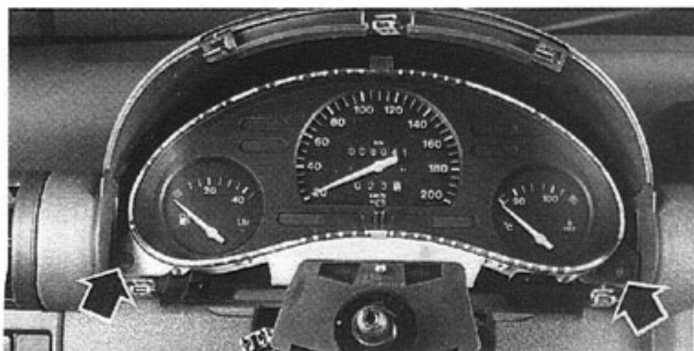
Rys. 11.15. Śruby mocowania zestawu wskaźników
