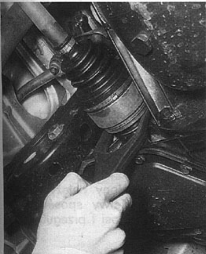
Rys. 6.1. Wyjmowanie półosi prawej za pomocą przyrządu KM-460-1
