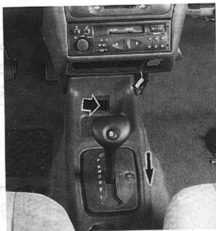
Rys. 11.22. Śruba mocowania i kierunek wyjmowania konsoli hamulca awaryjnego
