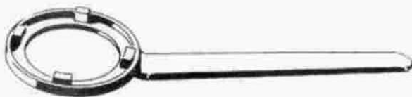
Rys. 2.78. KLUCZ DO ODKRĘCANIA CZUJNIKA POZIOMU PALIWA
