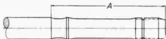
Rys. 3.46. MIEJSCE UMIESZCZENIA PRZEGUBU WEWNĘTRZNEGO NA DŁUŻSZYM KOŃCU PÓLOSI A = 135 mm pod tuleją osłaniającą przegub; przegub zewnętrzny jest mocowany na krótszym końcu półosi
