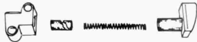
Rys. 2.40. ŁAŃCUCH ROZRZĄDU I NAPINACZ ŁAŃCUCHA (silnik 1,2)
