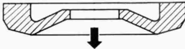
Rys. 2.96. PODKLADKA KSZTAŁTOWA WTRYSKIWACZA W TULEJCE IZOLUJĄCEJ CIEPLNIE MUSI BYĆ SKIEROWANA W STRONĘ GŁOWICY, JAK POKAZUJE STRZAŁKA
