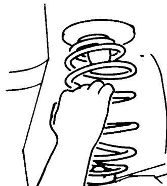
Rys. 5.28. WYJMOWANIE SPRĘŻYNY ZAWIESZENIA
