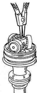
Rys. 4.76. PRZEGUB TRÓJPALCOWY JEST UMOCOWANY NA WALE PIERŚCIENIEM OSADCZYM. W przypadku półosi prawej należy najpierw usunąć osłonę gumową
