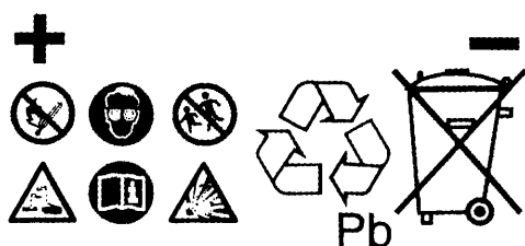
Rys. 14.1. Symbole dotyczące przepisów bezpieczeństwa umieszczone na obudowie akumulatora
