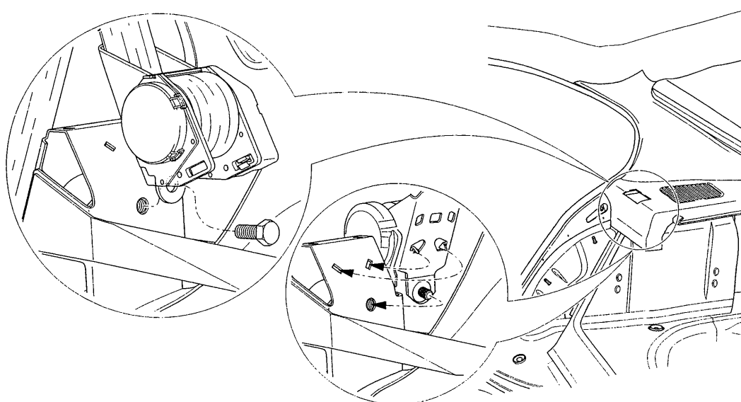
Rys. 15.132. Mechanizm zwijania pasa tylnych siedzeń
