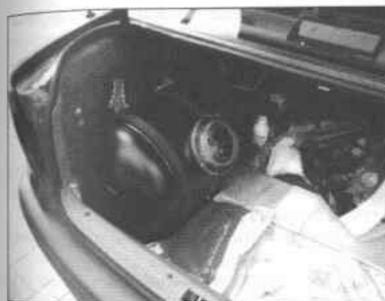
Fot. 5.3. Zbiornik walcowy zamontowany wzdłużnie w bagażniku za wneką tylnego koła
