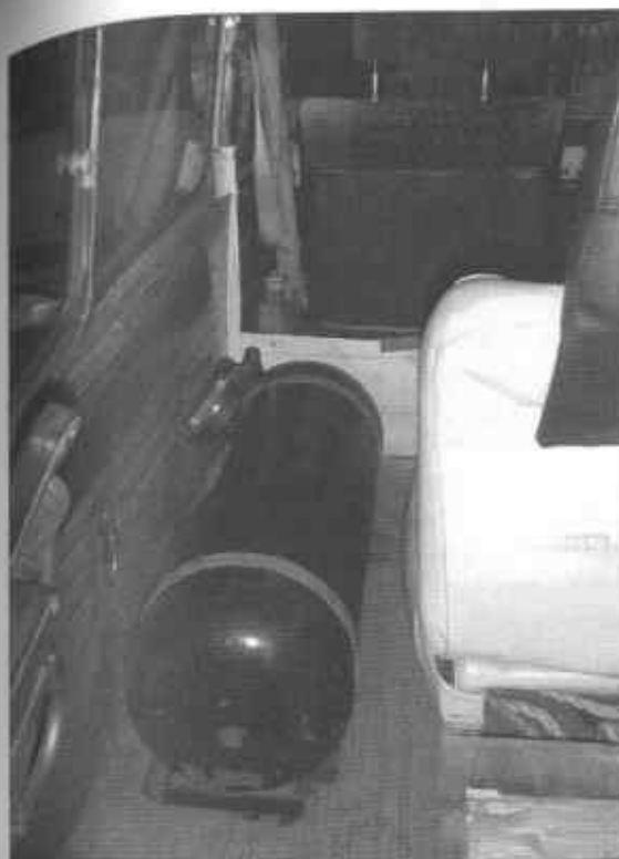
Fot. 5.10. Zbiornik walcowy umieszczony wzdłuż boku samochodu w przestrzeni pasażerskiej
