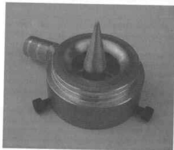
Fot. 3.21. Mieszalnik palnikowy przed i po mocowaniu jego charakterystyki
