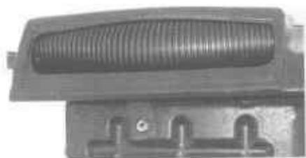
Fot. 3.7. Zablokowanie oryginalnego wlotu powietrza skierowanego do przodu samochodu [9]
