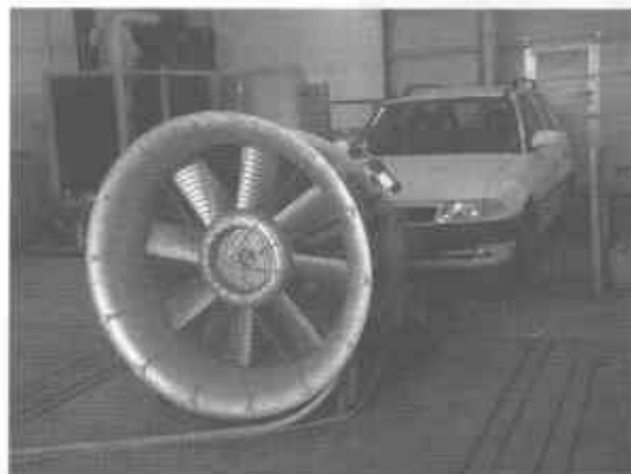
Fot. 3.9. Badanie wpływu prędkości nadmuchu powietrza na regulację składu mieszanki silników zasilanych LPG
