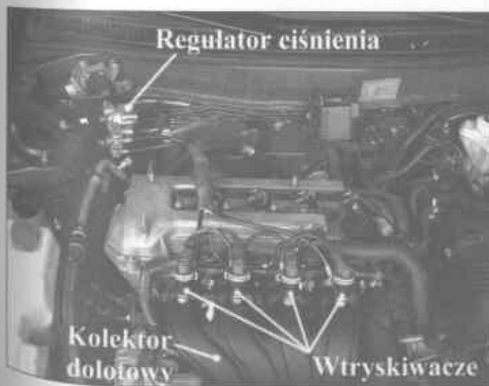
Rys. 4.22. Elementy składowe instalacji wtrysku fazy ciekłej zabudowane w komorze silnika
