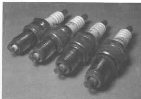
Fot. 3.20. Świece zapłonowe wymontowane z silnika o niesymetrycznym kolektorze dolotowym
