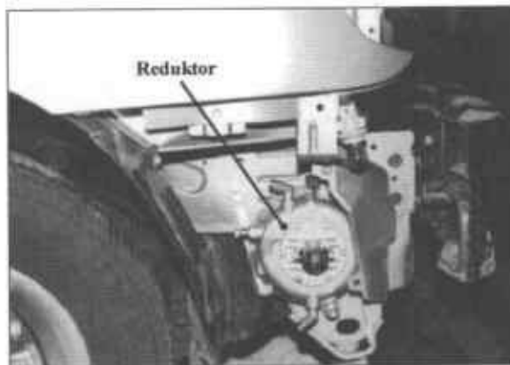
Fot. 3.18. Reduktor zamontowany po prawej stronie samochodu pod osłoną zderzaka
