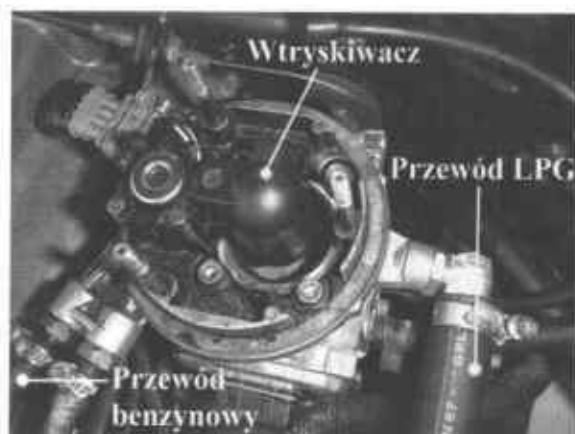
Fot. 3.29. Mieszalnik palnikowy zamontowany na płytce wtryskiwacza benzynowego
