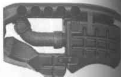
Fot. 3.8. Wywiercone otwory do pobrania powietrza w tylnej części elementu [9]
