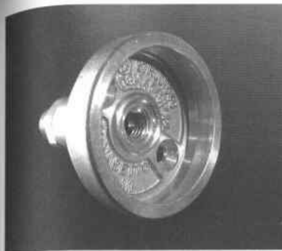
Fot. 5.21. Zawór tankowania wykonany według standardu włoskiego
