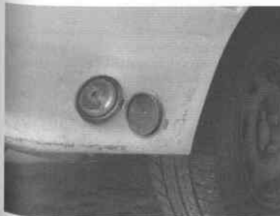
Fot. 5.23. Zawór tankowania montowany w zderzaku tylnym
