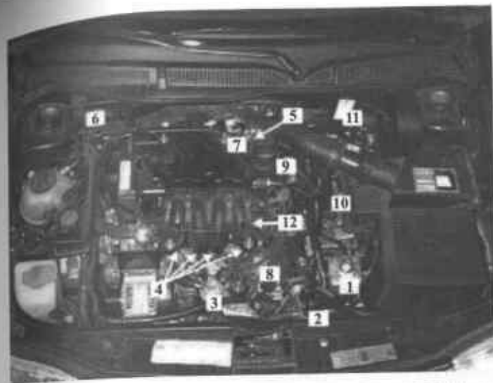
Fot. 4.6. Widok komory silnika z zaznaczonymi elementami instalacji IGS i miejscem ich zamontowania
