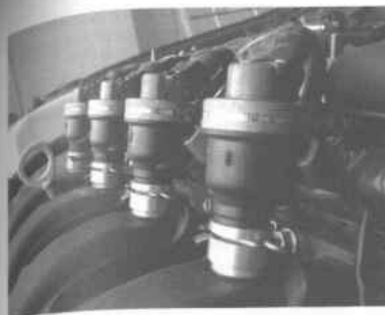
Fot. 4.19. Wtryskiwacze zamontowane w gniazdach wciśniętych w kolektor dolotowy
