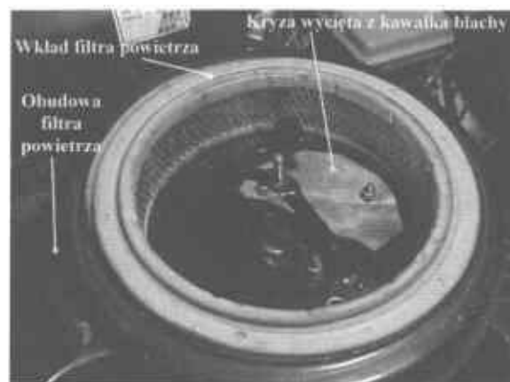
Fot. 3.3. Przesłona z blachy zamontowana w filtrze powietrza, zwiększająca podciśnienie w znajdującym się pod filtrem mieszalniku
