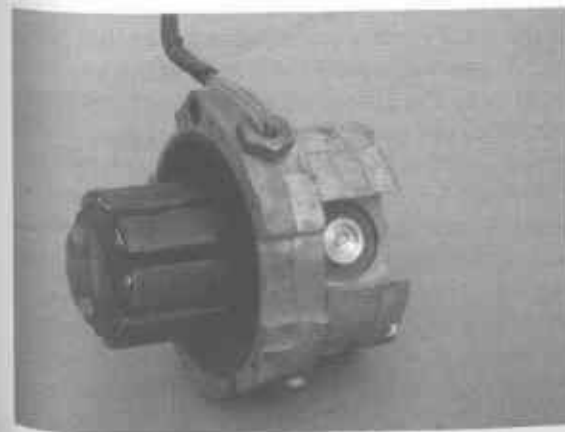
Fot. 4.16. Silnik prądu przemiennego pompy LPG
