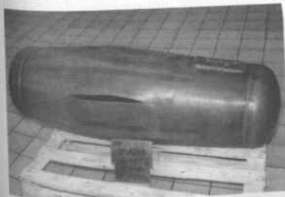
Fot. 5.16. Walcowy zbiornik LPG zniszczony w próbie rozrywania. Kształt zbiornika świadczy o zachodzących odkształceniach plastycznych (pożądanych), a sposób w jaki zbiornik pękł – o braku wad materiałowych oraz o dobrym wykonaniu połączeń spawanych
