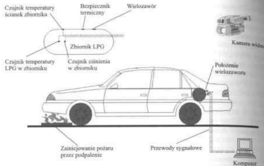
Rys. 6.10. Schematyczne przedstawienie samochodu przygotowanego do przeprowadzenia doświadczenia [13]
