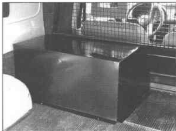
Fot. 5.9. Przykłady montażu zbiornika walcowego w przestrzeni ładunkowej
