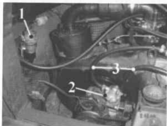
Fot. 6.5. Rozwiązanie wymuszenia obiegu cieczy 1 - pompa benzyny, 2 - oryginalna pompa paliwa wykorzystana do przepompowywania cieczy chłodzącej, 3 - przewody doprowadzające ciecz do reduktora
