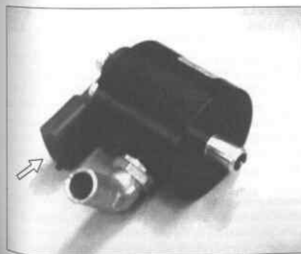
Fot. 4.8. Filtr LPG w fazie gazowej (tzw. moduł filtrujący) wraz z czujnikiem temperatury i ciśnienia fazy gazowej LPG (strzałka wskazuje złącze elektryczne do podłączenia przewodów sygnałowych)
