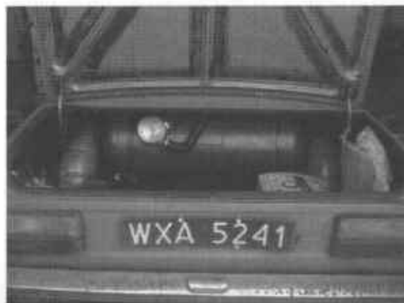
Fot. 5.1. Zbiornik walcowy zamontowany poprzecznie w bagażniku za oparciem tylnego siedzenia
