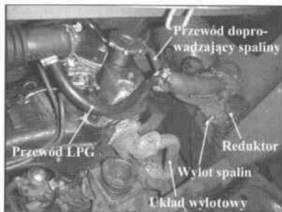
Fot. 6.1. Komora silnika Polskiego Fiata 126p z zamontowanym układem zasilania LPG
