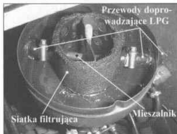
Fot. 3.22. Filtr powietrza z doprowadzonym do niego przewodem gazowym (zdjęcie górne) i wnętrze filtra z widocznym sposobem doprowadzenia LPG do siatki (zdjęcie dolne)
