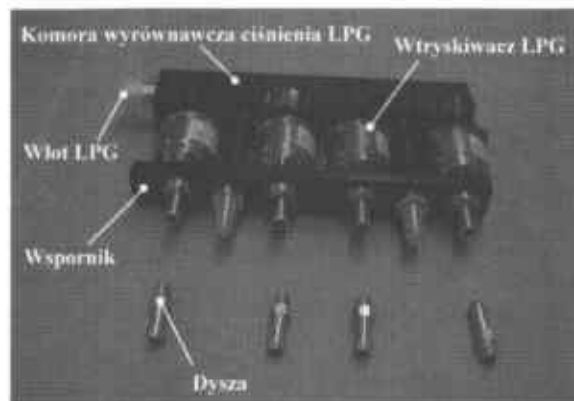
Fot. 4.9. Wtryskiwacze LPG zamontowane na wsporniku oraz dysze służące do wprowadzania LPG do układu dolotowego
