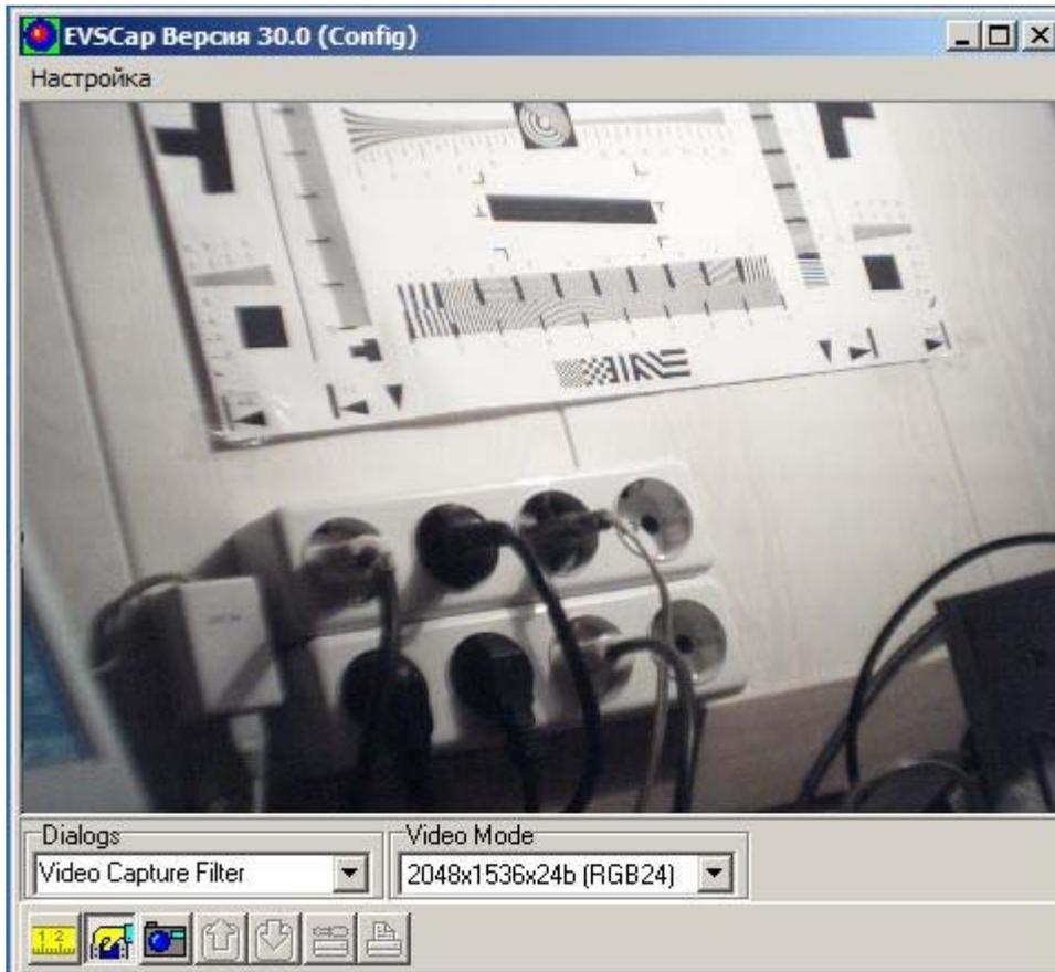
При достаточной мощности компьютера (частота процессора более 1,3 ГГц), частота отображаемых камерой кадров будет максимальной. По умолчанию, камера устанавливается в режим максимального формата изображения, например, 2048 x 1536 в камере VEC-335., однако при необходимости, формат можно уменьшить, что иногда необходимо при использовании камеры в качестве WEB - камеры. Для смены формата нужно выбрать закладку «Video Mode» и выставить соответствующий формат изображения.
