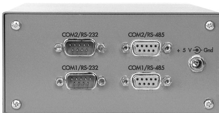
Рисунок 5. Панель разъемов устройства UniLink
