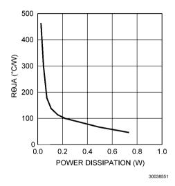
FIGURE 12. R<sub>AJA</sub> vs Internal Dissipation
