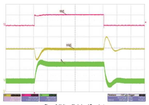
Figure 6. Voltage-Mode Load Transient
