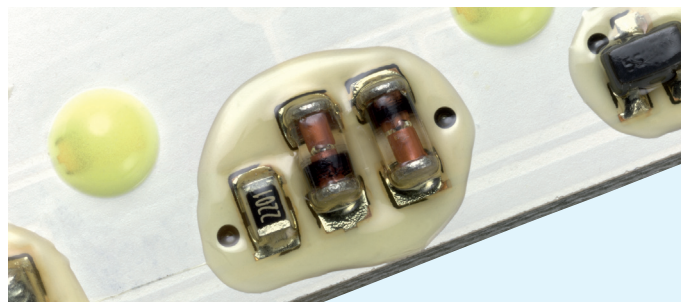
Durch den Schutzlack gegen Luftfeuchtigkeit geschützte Elektronik.
