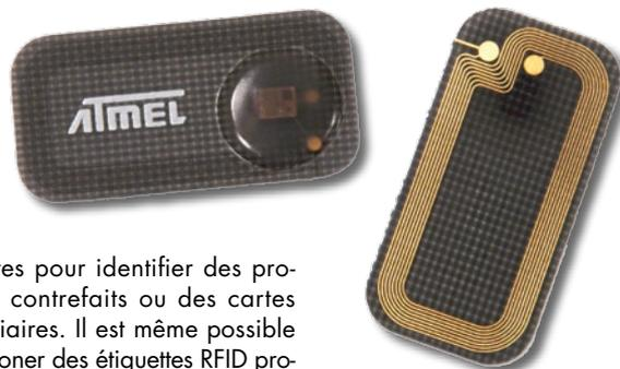
quettes pour identifier des produits contrefaits ou des cartes fiduciaires. Il est même possible de cloner des étiquettes RFID protégées par mot de passe vu qu'il est possible de capturer le mot de passe lors d'une transaction voire lors d'une simple lecture du composant. Ceci n'est pas le cas des composants CryptoRF dotés d'un moteur d'encryptage
