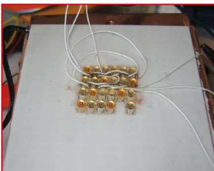
Câblage de la première moitié des LED au moyen de fil wire-wrap au Kynar. On peut éventuellement rigidifier le câblage au moyen de colle instantanée mais dans ce cas, plus question de réparer facilement.
