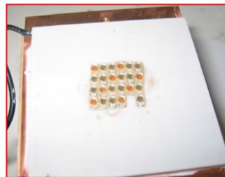
Les LED une fois collées à l'élément Peltier au moyen de colle compound thermique.
