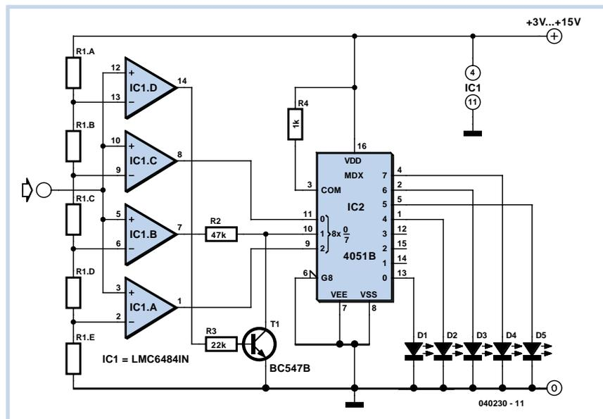
Le seul endroit du circuit qui réclame éventuellement une explication concerne T1. Ce transistor ramène à zéro l'entrée 1 de sélection de canal en la court-circuitant, donc en prenant le pas sur la sortie de IC1.B, la broche 7. Ceci induit un nouveau nombre binaire (101) à l'entrée de IC2 et ajoute un cinquième étage à l'histogramme. On peut également utiliser à la place de T1 un MOSFET « logique », genre BUZ11 ou IRF510, auquel cas, on peut supprimer R1.
