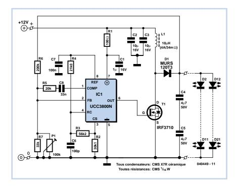
Cette rampe est comparée à une fraction de la tension de sortie qui est ramenée au comparateur par le diviseur de tension R6/R7. Le potentiomètre ajustable P1 est là pour permettre de régler la tension de sortie en fonction des besoins en courant direct des LED utilisées.
