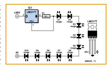
sitif de refroidissement adéquat). Dans le cas d'un courant de 10 mA et d'une chute de tension aux bornes du LM317 de, disons, 4 V, la dissipation n'est que de 40 mW, ce qui nous permet de nous passer de radiateur. En cas de court-circuit, le dispositif interne de protection contre un court-circuit et un suréchauffement entre en fonction de sorte que l'on ne risque rien non plus de ce côté-là.
