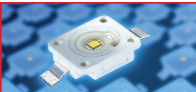
Le « Platinum Dragon » blanc rayonne 75 lm sous un courant de 700 mA ; avec cette puissance, le rendement est de 30 lm/W. Le boîtier correspond en conception et en dimensions à la LED de forte puissance « Golden Dragon » du même fabricant, mais délivre le double de puissance. Pour un prix inférieur à trois dollars étasuniens, le « Platinum Dragon » devrait offrir le meilleur rapport « qualité-luminosité » du marché.
