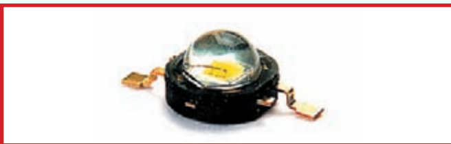
Aux dires du fabricant, le modèle P4 de Seoul Semiconductor est la LED la plus lumineuse au monde et atteint avec une puce unique une intensité supérieure à 240 lm (sous 1 A). Sous 350 mA, le rendement lumineux est au maximum de 100 lm/W. Cette valeur devrait être portée à 135 lm/W dans le courant de l'année et à 145 lm/W pour le premier trimestre 2008.
