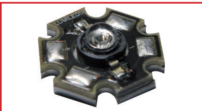
La « Luxeon III Star Hex » de Lumileds atteint 80 lm en blanc et 190 lm en orange. Le dissipateur en forme d'étoile à six branches est caractéristique.
