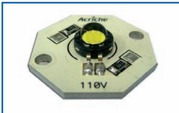
Figure 5. Les modules LED Acriche de Seoul Semiconductor peuvent être alimentés sans transformateur, directement à partir d'une prise de courant. Une LED unique de 2 watts. Le fabricant s'est donné pour but d'augmenter la luminosité des 48 lm/W actuels à 80 lm/W au cours du premier trimestre 2007 et à 120 lm/W en 2008.
