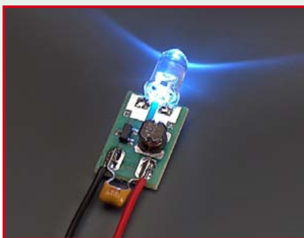
Figure 2. Condensateurs de découplage supplémentaires.
