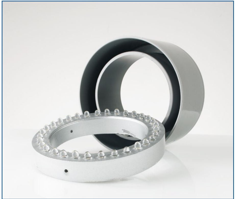
Figuur 5. Onze LED-ringflitser is gemaakt van een verbindingstuk dat in iedere bouwmarkt te vinden is.
